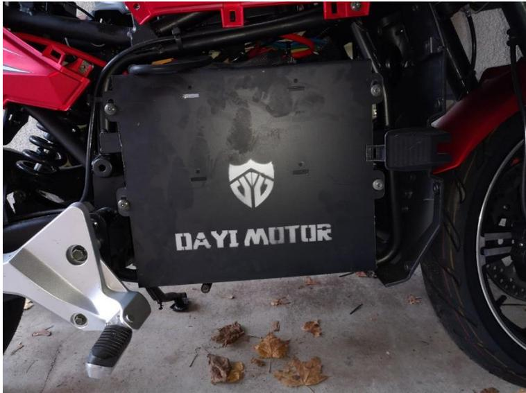
Die Batterie-Abdeckung ist aus ca. 2mm Stahlblech und mit 4 Inbus-Schrauben (M6) am Rahmen festgeschraubt.
