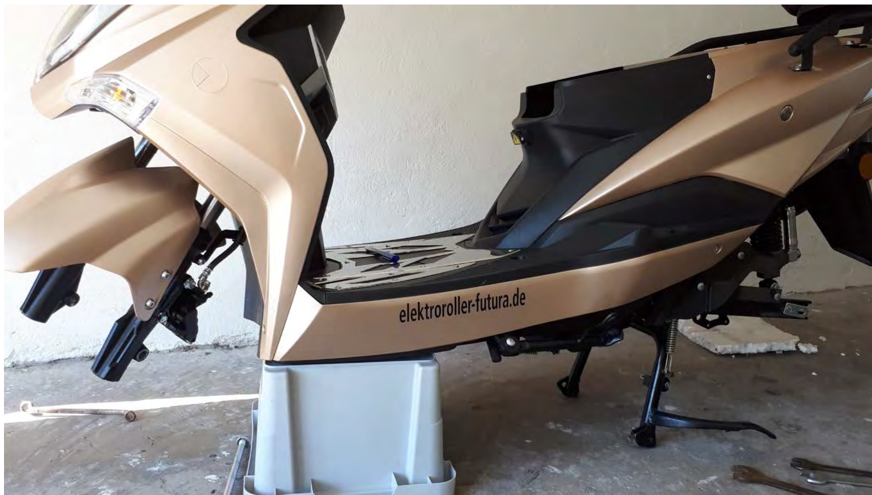
So kann der HAWK dann ganz einfach abgestützt werden, wenn beide Räder ausgebaut werden.
