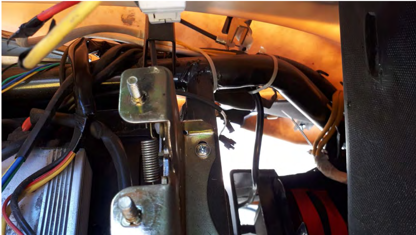
Blick hinter der Sitzbank nach Ausbau der Sitzbank: Rechts im Bild deutlich zu sehen der senkrechte Verlauf des Phasenkabelstrangs in Richtung Hinterrad
