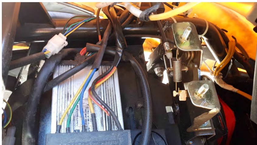
Steuercontroller noch mit Isolier-Abdeckung der Phasenkabel
