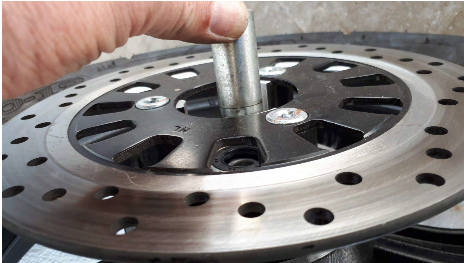
Die lange Distanzhülse kommt auf die Seite der Bremsscheibe
