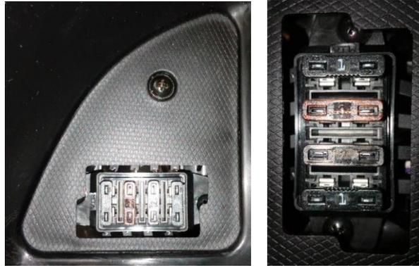
El scooter dispone de 4 fusibles, de izquierda a derecha (respecto a la posición del conductor):
