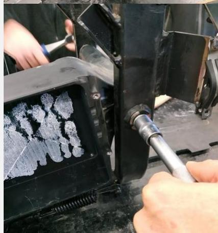
4. Extraer el eje y el distanciador que queda en el basculante
