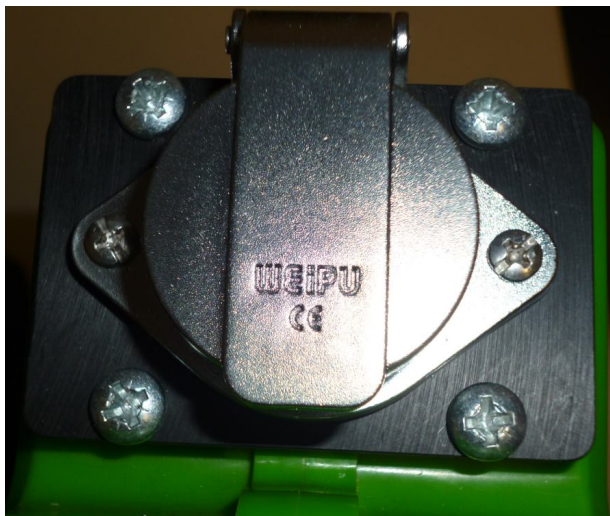
Abbildung 13 Fertige Buchse auf Batterie
