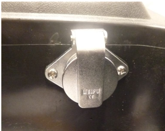
Abbildung 4 Eingebaute Weipu Ladebuchse
