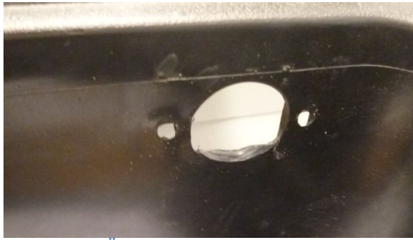
Abbildung 3 Öffnung für die Ladebuchse
