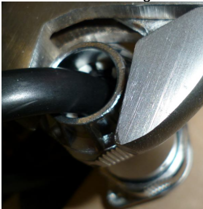
Abbildung 7 Festziehen der Zugentlastung
