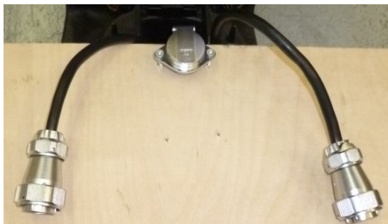
Abbildung 6 Komplett umgerüsteter Steckersatz im Roller
