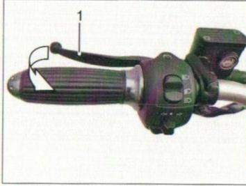
Handbremshebel für Hinterradbremse
