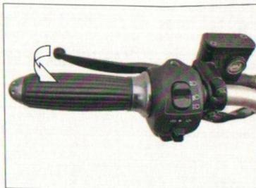
Handbremshebel für Hinterradbremse
