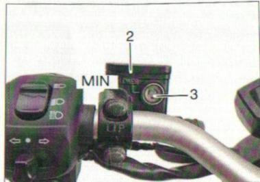
Bremsflüssigkeitsbehälter für Hinterradbremse
