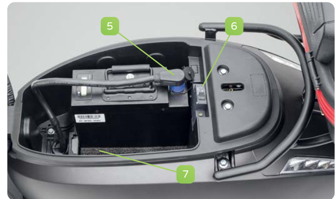
Akkufach unter dem Sitz mit geschlossenem Ladekabel
