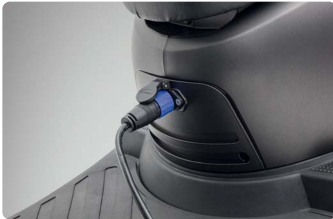
Eingangsstecker an Ladebuchse
