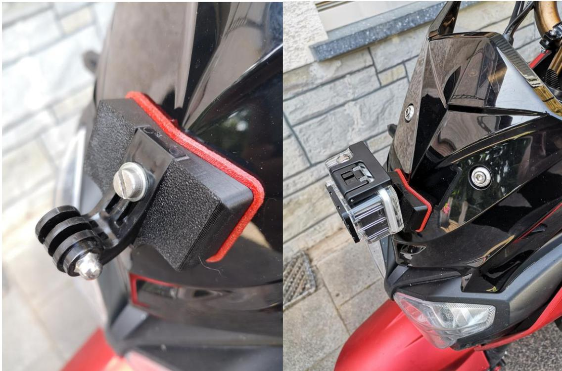
Nun kann bspw. ein wasserdichtes Kameragehäuse sicher vorne am Bike befestigt werden.
